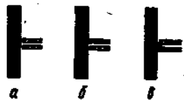
Рис. 5. Различные типы капилляров Лuggина
