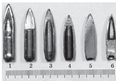
Рис. 13. — Некоторые конструкции пуль: 1 — модернизированная пуля БЗТ; 2 — трассирующая пуля Т-46; 3 — бронебойно-зажигательная пуля Б-32; 4 — пуля ЛПС; 5 — тяжёлая пуля Д; 6 — снайперская пуля ПС
