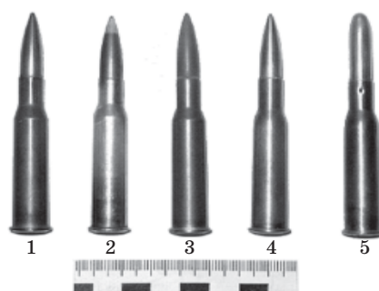
Рис. 12. — Патроны 7,62×53 (7,62×54): 1 — патрон со стальной лакированной гильзой и пулей ЛПС; 2 — патрон со стальной гильзой без покрытия и пулей Д; 3 — патрон со стальной биметаллической гильзой и пулей Л с оцинкованным покрытием; 4 — патрон с латунной гильзой и пулей Л; 5 — патрон с латунной гильзой и пулей образца 1891 г.
