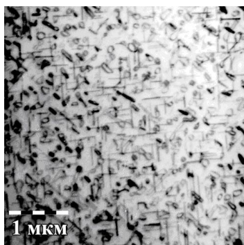
Рис.1. ПЭМ фотография кремния, легированного бором в один шаг дозой 1,5 \cdot 10^{15} cm^{-2} . Отжиг БТО в течении 10 секунд при 1000 °C в N_2 (SiB-1).
