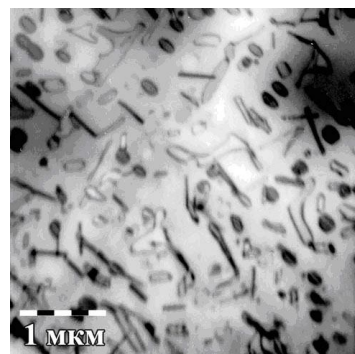
Рис.2. ПЭМ фотография кремния, легированного бором в четыре шага дозой (1+2+4+8) \cdot 10^{14} cm^{-2} . Отжиг БТО в течении 10 секунд при 1000 °C в N_2 (SiB-2).
