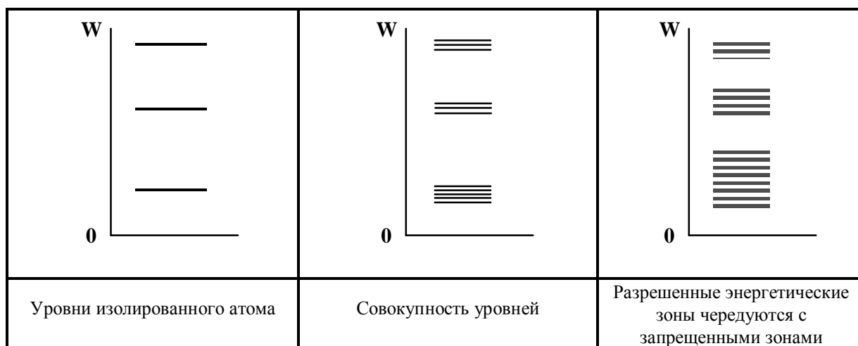
Рисунок 2 – Схема образования разрешенных и запрещенных энергетических зон атомов твердого тела
